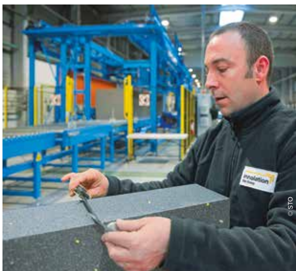
▲ CONTRÔLE DE LA PRÉCISION DIMENSIONNELLE EN SORTIE DE DÉCOUPE
